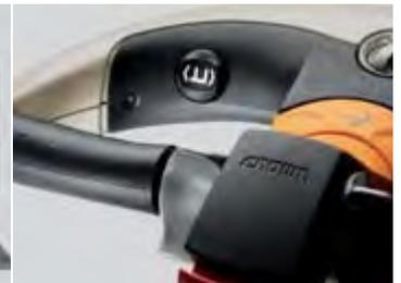
**Tablier à déplacement latéral avec commande intégrée :** il permet à l'opérateur de déplacer la charge vers la gauche ou la droite (course totale 100 mm). Le commutateur d'activation de cette fonction est intégré au timon X10 de Crown (SX uniquement).
