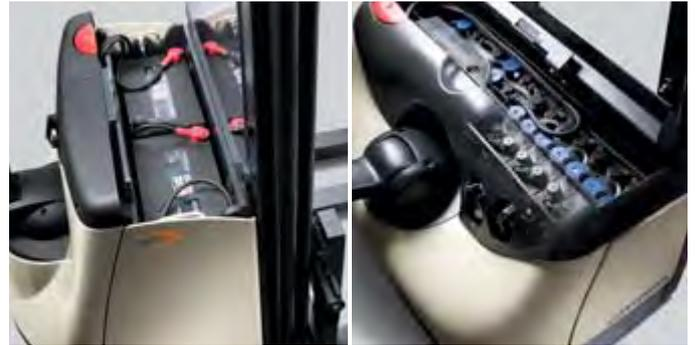
**Options batteries multiples :** plusieurs options de batteries sont proposées. Batteries sans entretien jusqu'à 192 Ah, batteries industrielles à plombs ouverts jusqu'à 180 Ah (représentée ici avec système de remplissage centralisé, en option).
