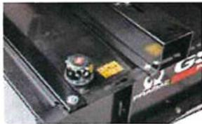
Réservoir métallique intégré
