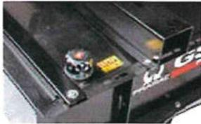
Réservoir métallique intégré
