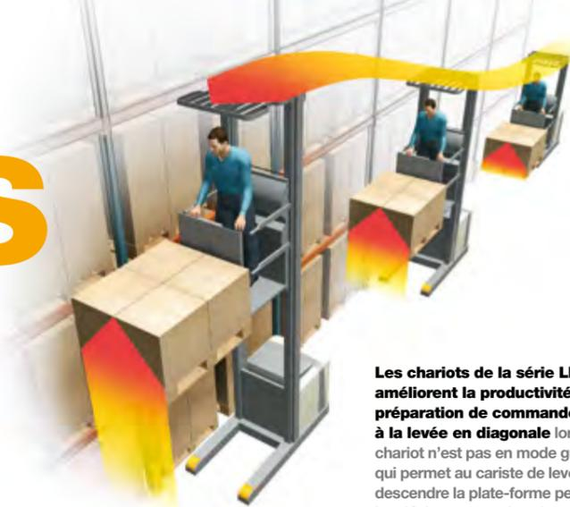
**Les chariots de la série LP 3500 améliorent la productivité pour la préparation de commandes grâce à la levée en diagonale** lorsque le chariot n'est pas en mode guidé, qui permet au cariste de lever et descendre la plate-forme pendant les déplacements dans les allées ou en dehors de celles-ci. La vitesse se règle automatiquement selon la hauteur de la plate-forme et l'angle de braquage.
