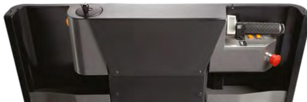
**Les caristes bénéficient de commandes électroniques ergonomiques** avec activation instantanée au toucher, direction électronique, trois réglages de niveau de performance, démarrage avec commutateur à clé ou code PIN et messages concis que le cariste peut facilement lire sur l'affichage.
